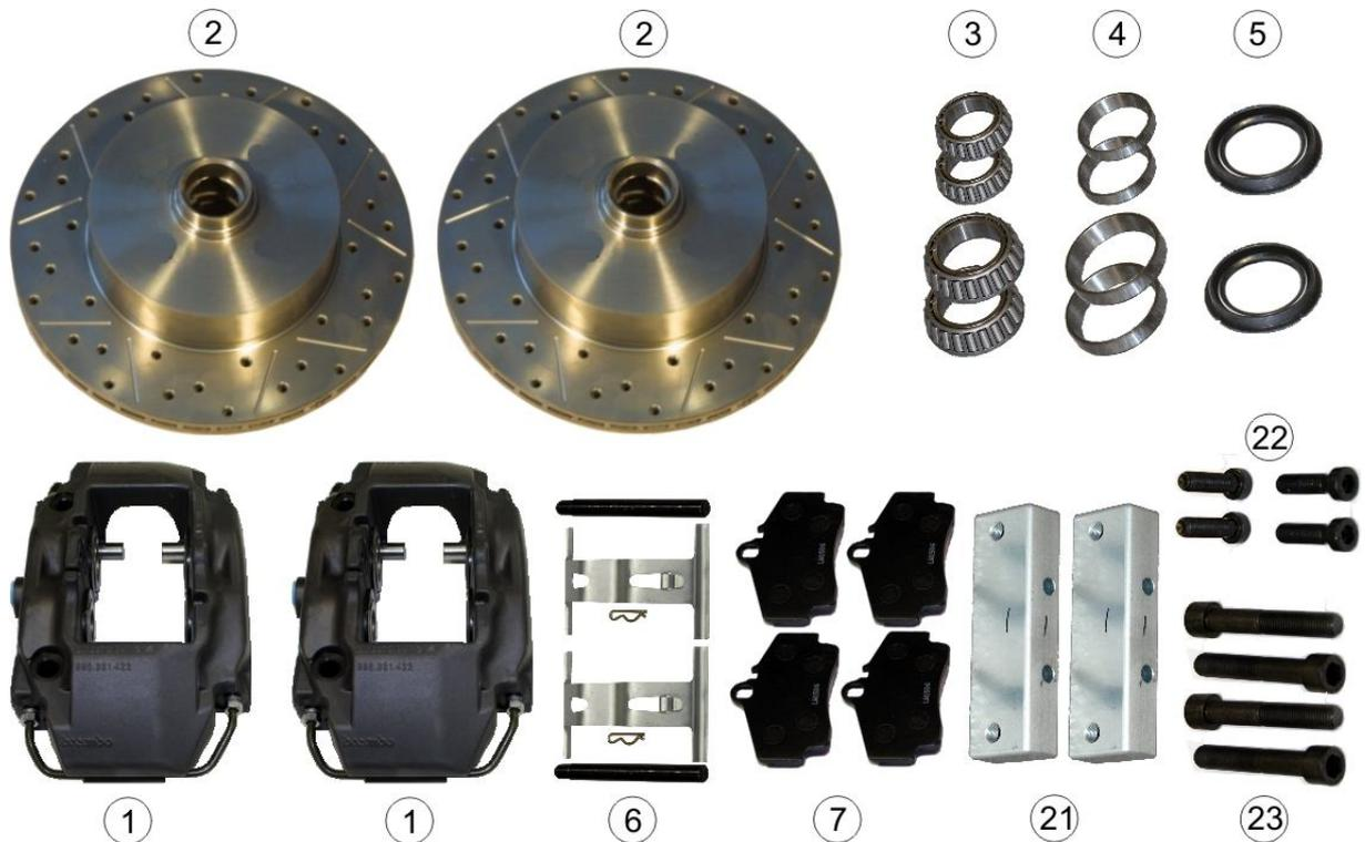
Unsere Bremsanlagen 4- oder 5-Loch können bei allen VW-Käfer-Modellen verbaut werden, die entweder serienmäßig mit Achsschenkeln für Bremsscheiben ausgerüstet sind oder nachträglich auf diesen Stand umgerüstet wurden.
