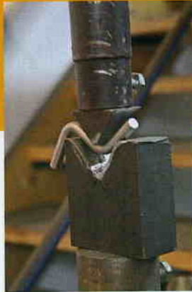
Auch die Aufhängungsteile der Abgasanlage werden auf Maß gefertigt, mithilfe einer Presse werden die Edelstahlstifte in Form gebogen.
