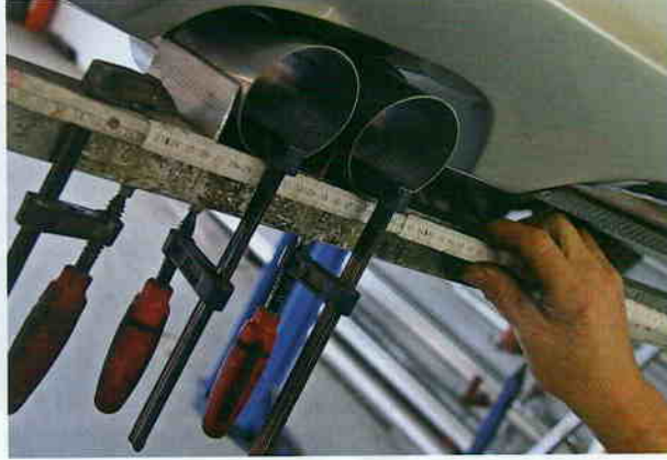
Kaum etwas sieht an einem getunten Auto unvorteilhafter aus als schiefe Endrohre, deshalb wird höchster Wert auf eine gerade Ausrichtung gelegt.
