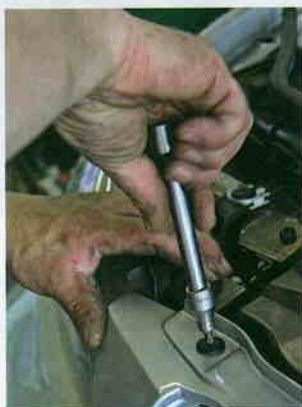
Mit insgesamt 13 Schrauben wird jetzt auch die Frontschürze an der Karosserie befestigt, nachdem sie ebenfalls im Detail noch ein wenig angepasst wurde.
