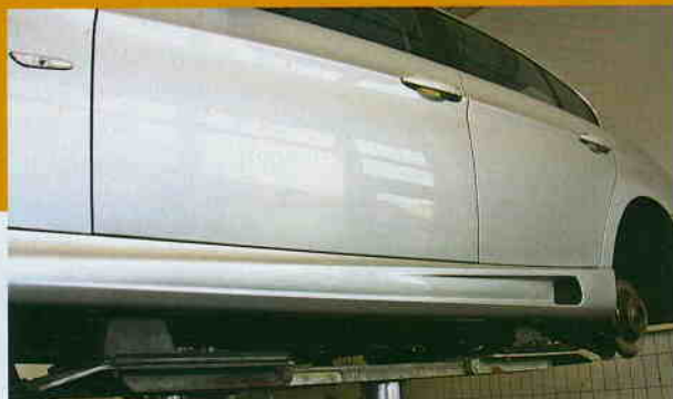
So weit, so gut: Die Schwellerverkleidung wird von zehn Schraubverbindungen an ihrem Platz gehalten, der Karboneinsatz folgt später.
