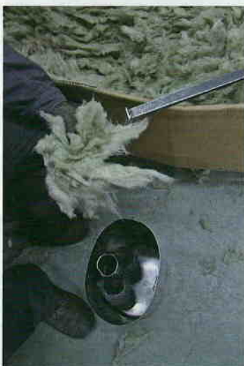
Schallschluckende Steinwolle füllt das Innere der beiden Endschalldämpfer und des Vorschalldämpfers komplett aus.
