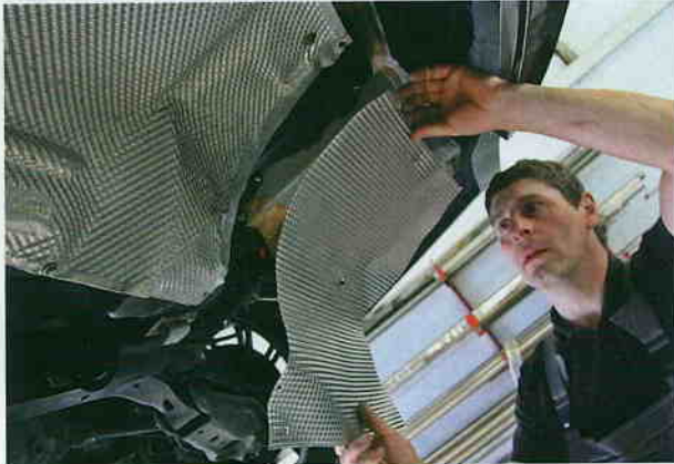
Bevor die Endtöpfe ihre endgültigen Plätze einnehmen, muss an der rechten Seite noch das Hitzeschutzblech ergänzt werden.
