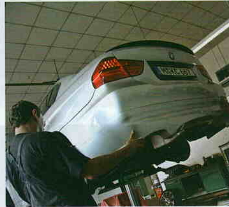
Stefan und sein Kollege halten jetzt den Heckschürzenansatz probeweise an seinen Platz. Auch dieses Teil wird vor dem Einbau noch feinbearbeitet.
