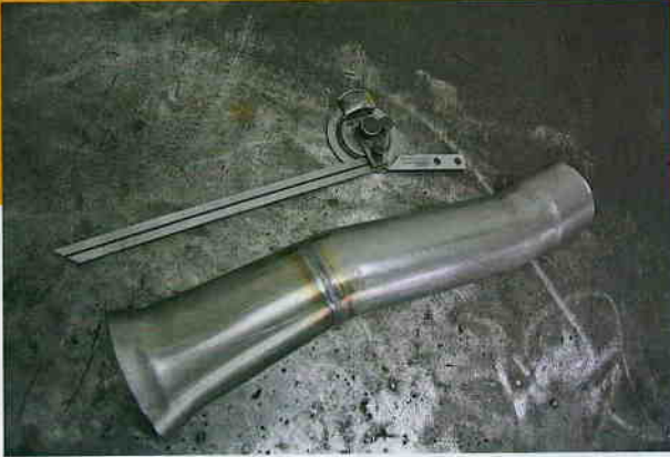
Mit Winkelmesser und Augenmaß wird das Verbindungsrohr angefertigt, das später die beiden Endschalldämpfer mit dem Vorschalldämpfer verbindet.
