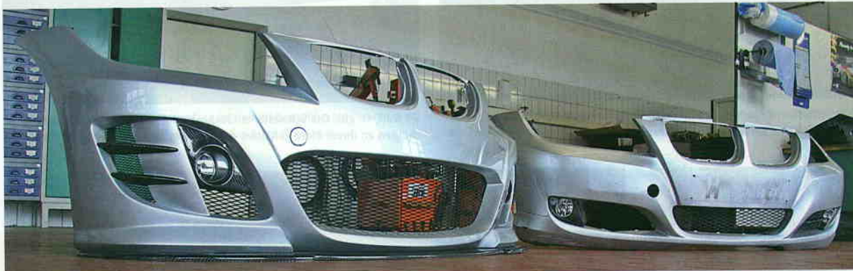
Seite an Seite stehen die fertig lackierte Kerscher-Schürze und das Originalteil nebeneinander. GFK-Teile werden selbst entwickelt und in eigenen Formen gefertigt.
