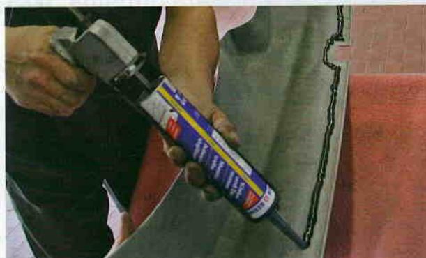
Anschließend wird Karosseriekleber gleichmäßig auf das Kunststoffteil aufgetragen. Der flexible Klebstoff verbindet den Schürzenansatz dauerhaft mit der Stoßstange.
