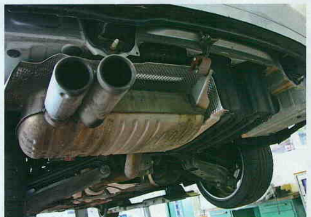
Rechts vom Originalschalldämpfer ist die Reserveradwanne zu erkennen, an dieser Stelle soll am Schluss der zweite Endschalldämpfer sitzen.
