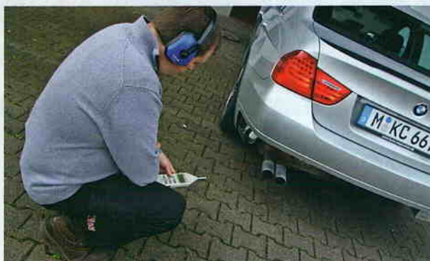
Bevor es richtig losgeht werden eventuelle Schäden am Fahrzeug dokumentiert, nach dem Demontieren der Serienheckschürze folgt die Messung der Original-Lautstärke.
