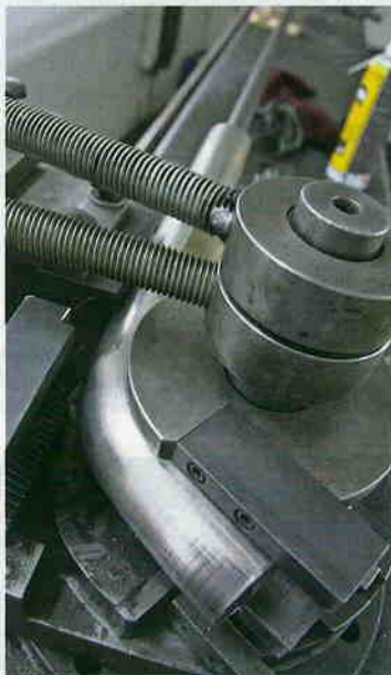
Auf einer Dornbiegemaschine werden die Bögen der Verbindungsrohre in Form gebracht. Diese Technik verhindert, dass sich der Rohrquerschnitt beim Biegen verringert.
