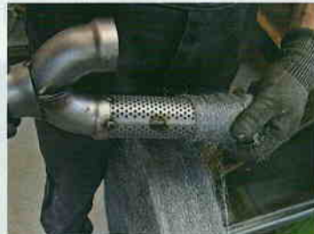
Aus gelochten Blechen punktet Stefan passende Rohre zusammen, die dann an das Y-Rohr geschweißt und mit Edelstahlwolle umwickelt werden.
