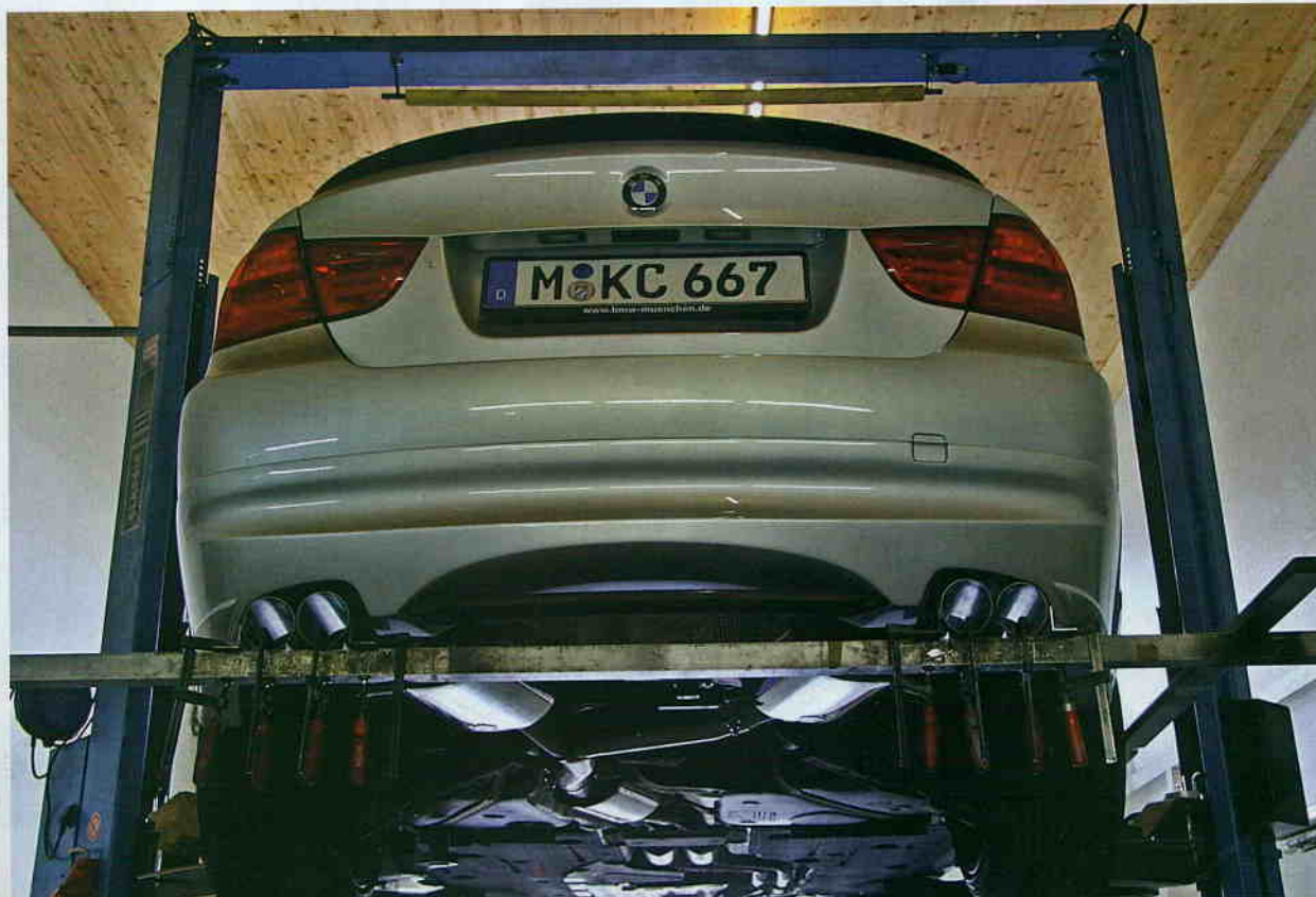
Mit Wasserwaage, einem robusten Alubalken und mehr als einem halben Dutzend Schraubzwingen werden alle vier Endrohre in ihrer späteren Lage befestigt.
