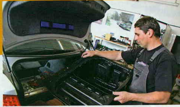
Die Kofferraumwanne mit Vertiefung weicht dem flachen Gepäckraumboden vom 335i, auch muss der Aktivkohlefilter der Tankentlüftung versetzt werden.
