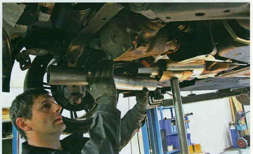
Immer wieder nimmt Stefan am Fahrzeug Maß und prüft, ob die bereits fertiggestellten Teile auch so ausgerichtet sind wie geplant.
