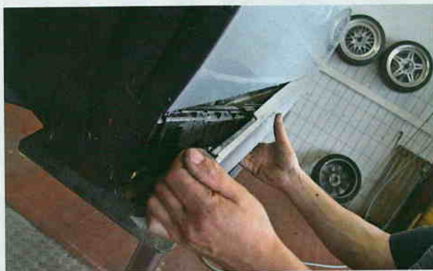
Im nächsten Schritt werden die serienmäßigen Schwellerblenden ausgeklippt und abgenommen.
