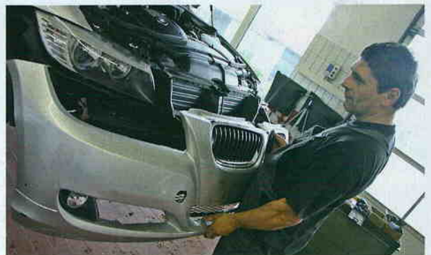
Zunächst kümmert sich Stefan Reisbeck um die Front, indem er alle Verschraubungen und Stecker löst, bevor er die vordere Verkleidung abnimmt.
