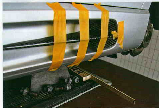
Auch die Karboneinsätze an den seitlichen Lufteinlässe werden jetzt eingesetzt und fixiert.
