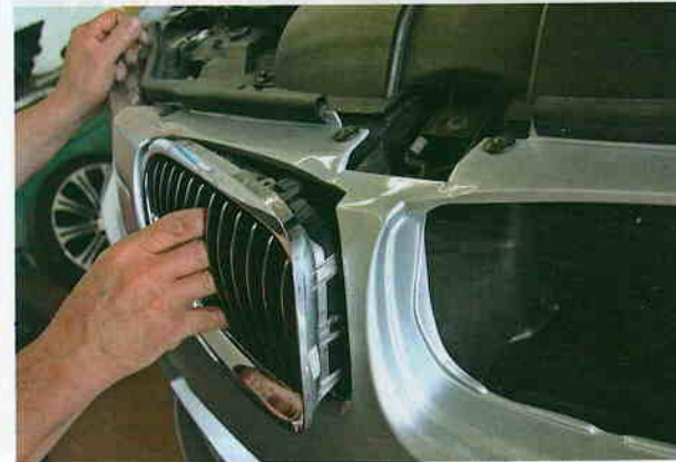
In der neuen Frontschürze können die serienmäßigen Nieren weiterverwendet werden, die Ziergitter rasten in den Öffnungen sauber ein.
