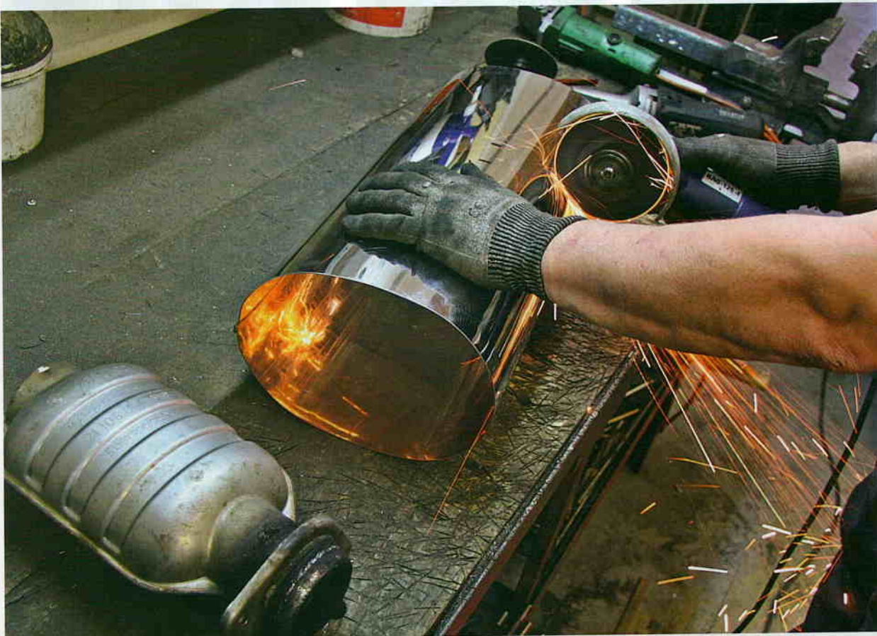
Vom Edelstahl-Rohmaterial werden mit dem Trennschleifer passende Stücke abgelängt, aus denen der Ersatz für den Vorschalldämpfer und die Endtöpfe entsteht.
