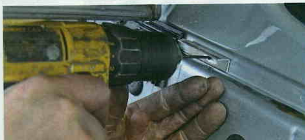
Die Haltewinkel der neuen Schwellerverkleidungen werden direkt mit der Karosserie verschraubt.
