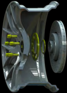
Adapterring ohne Bund und Radschrauben adapter ring without collar and wheel bolt
