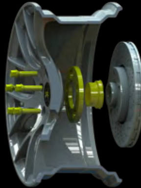
Adapterring mit kurzem Bund und Radschrauben adapter ring with short collar and wheel bolt
