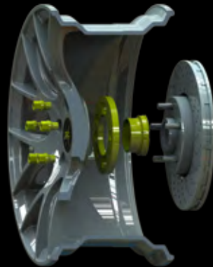
Adapterring mit kurzem Bund und Schaftmuttern adapter ring with short collar and shaft nuts
